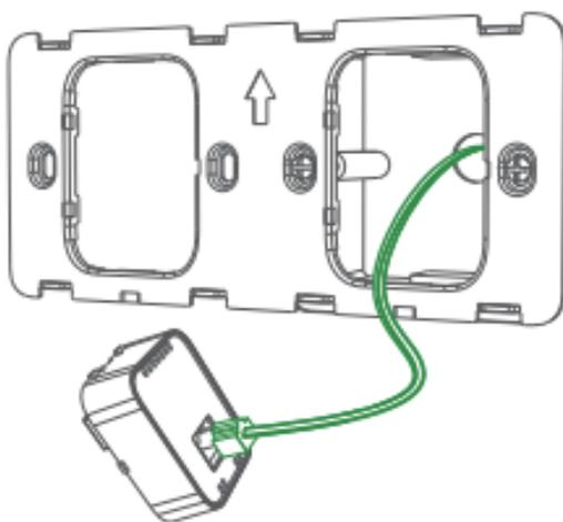
第三步：将电源盒按图示方向插入铁背板，听到咔的一声即可，保证表面与铁背板平行；
